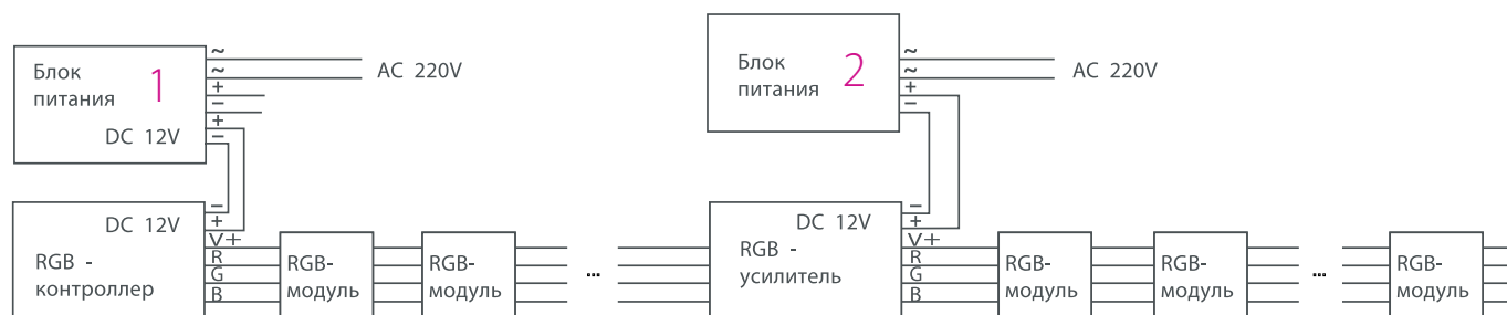
Схема 2. Последовательное подключение. Блоки питания 2шт или более.
